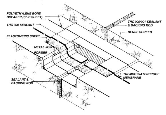
TRAFFICABLE SURFACE JOINT AT DOOR SILL Alternative
