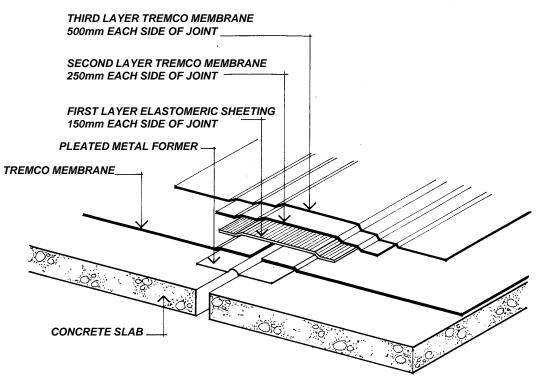
HORIZONTAL EXPANSION JOINT (FOR DOUBLE LAYER)
